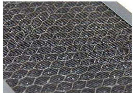
特色：蜂巢式過濾網，有效將活性炭等吸附顆粒隔絕在每個小蜂巢內，使得顆粒不會有沈積情形，可以達到較低的壓損。適用於低污染濃度的條件。針對不同的化學氣體，可選用不同的濾材，以達到最好的處理效果。
